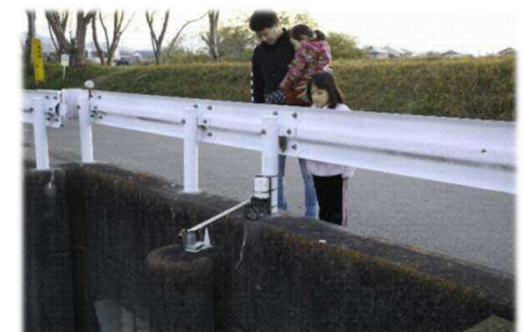
河川水位観測システム 16
