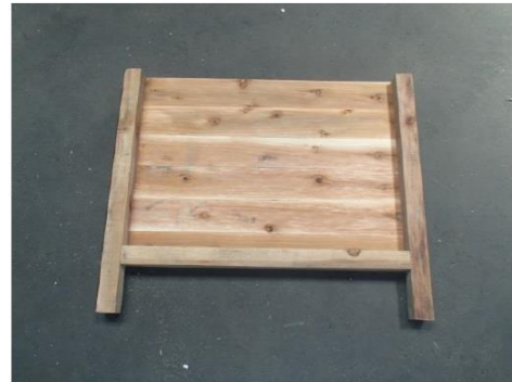
本体用材料(1)板①と(2)角材①と③をネジで固定。
