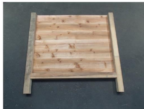
本体用材料(1)板②と(2)角材②と③をネジで固定。
