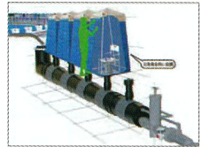
マンホールトイレ
