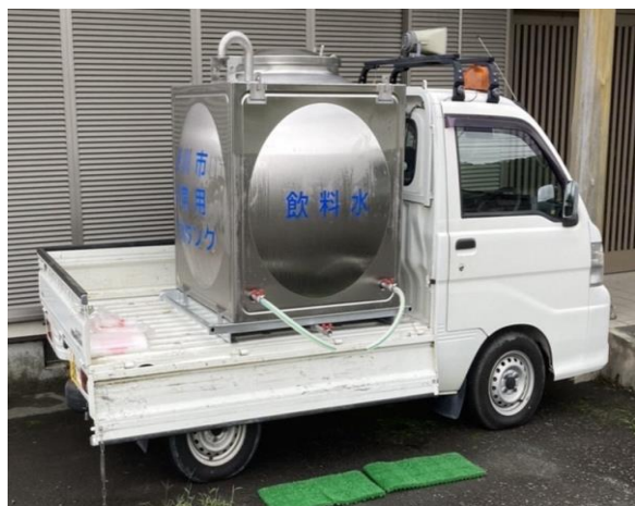
仮設給水タンク（可搬式水槽）
