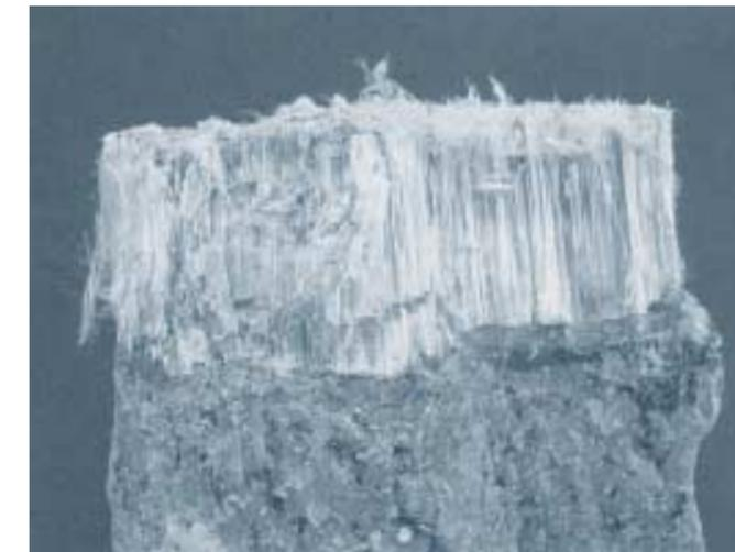
建物に使用されるアスベスト(石綿)は、飛散性の違いから、吹き付け石綿と石綿含有建材とに分類することができます。
